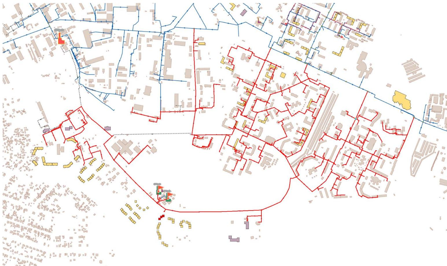
**Рисунок 15. Перспективное положение новой БМК взамен Котельной «Мамонтовская» (сети теплоснабжения, подключенные к новой БМК, выделены красным цветом)**
