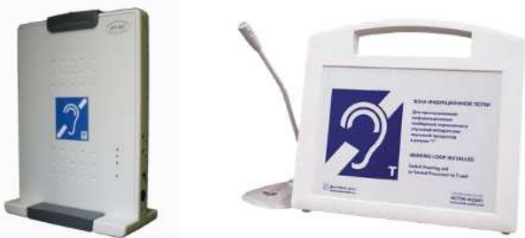
Переносная информационная система "Исток А1" и "А2" состоит из микрофона и передающей панели
