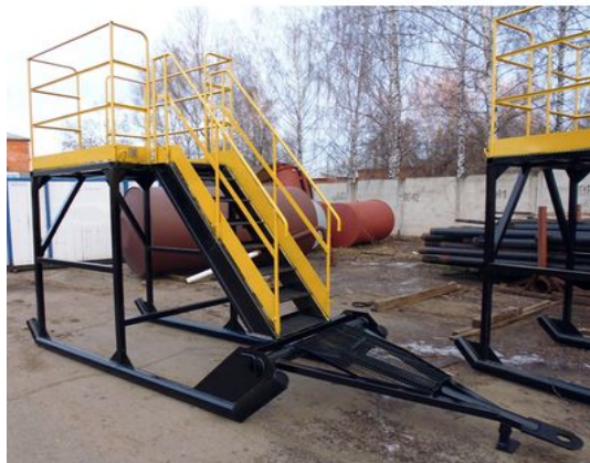
площадки для обслуживания скважин
